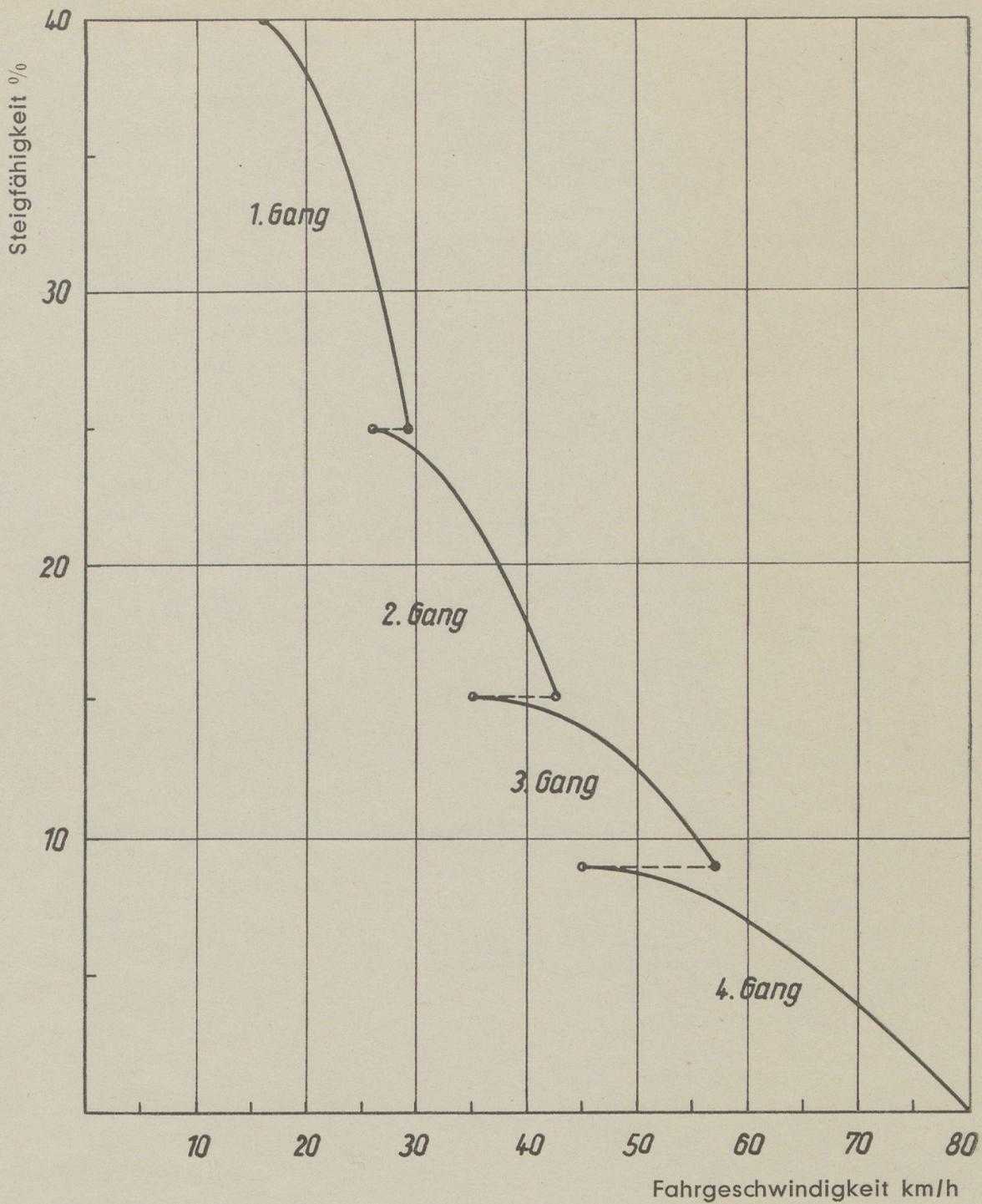
Steigfähigkeit in den einzelnen Gängen aufgetragen über der Fahrgeschwindigkeit.
